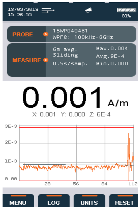
Figura 2: Grafiku i fortësisë së fushës magnetike H (A/m) në intervalin e kohës.
