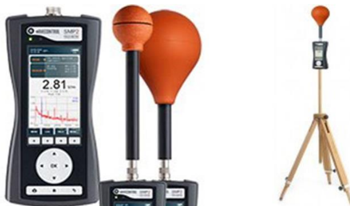
Fig1. Pajisjet e përdorura për monitorimin e rrezatimeve jojonizuese.
