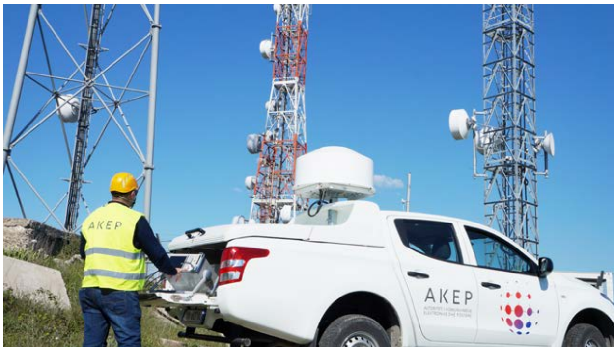
Figure 22: Punë monitoruese të spektrit të frekuencave për interferenca të dëmshme Burimi: AKEP 2020
