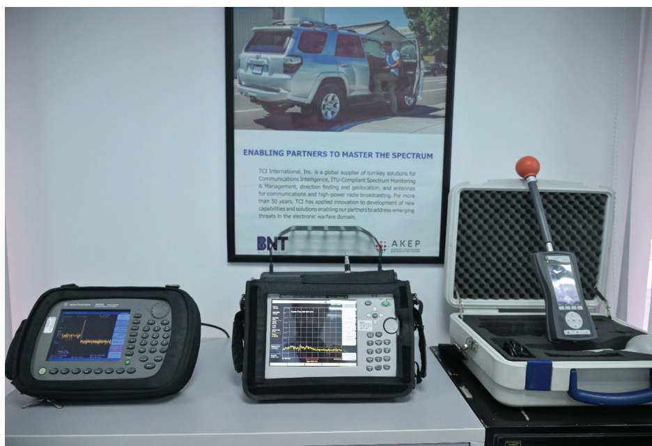
Pajisje të përdorura për monitorimin e spektrit të frekuencave (Burimi: AKEP)
